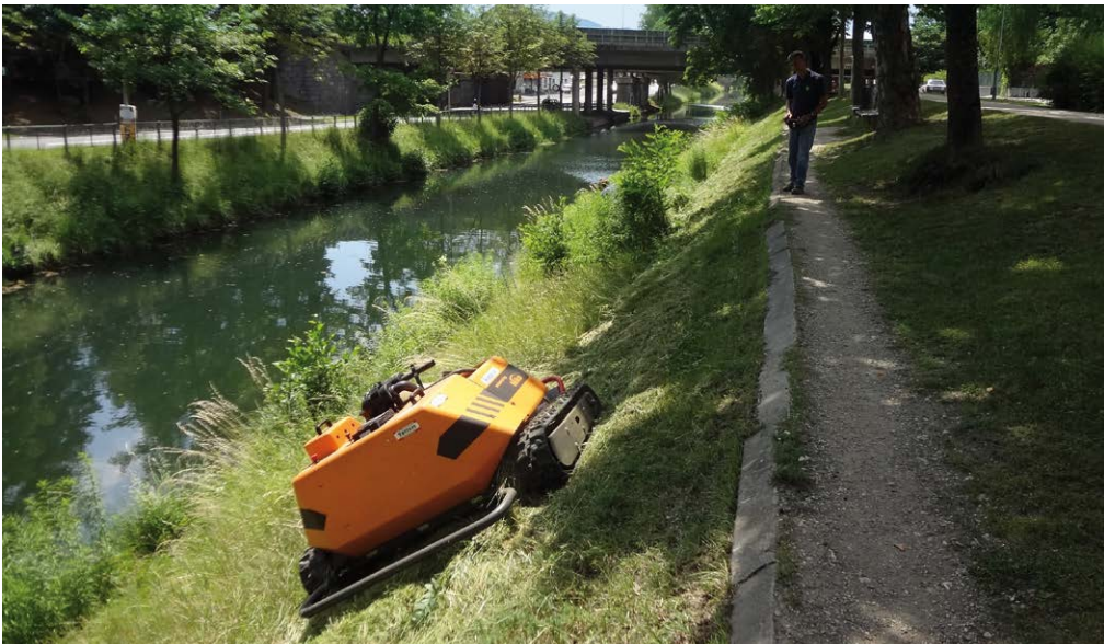
Ferngesteuerter Raupenmäher statt Motorsense: Kostengünstige Pflege von Steilflächen.
