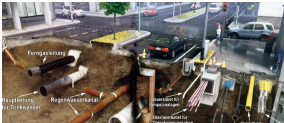
Abb. 35: Beanspruchung des städtischen Bodenraums durch technische Infrastruktur (RWE-Magazin 02/2006 (verändert))
