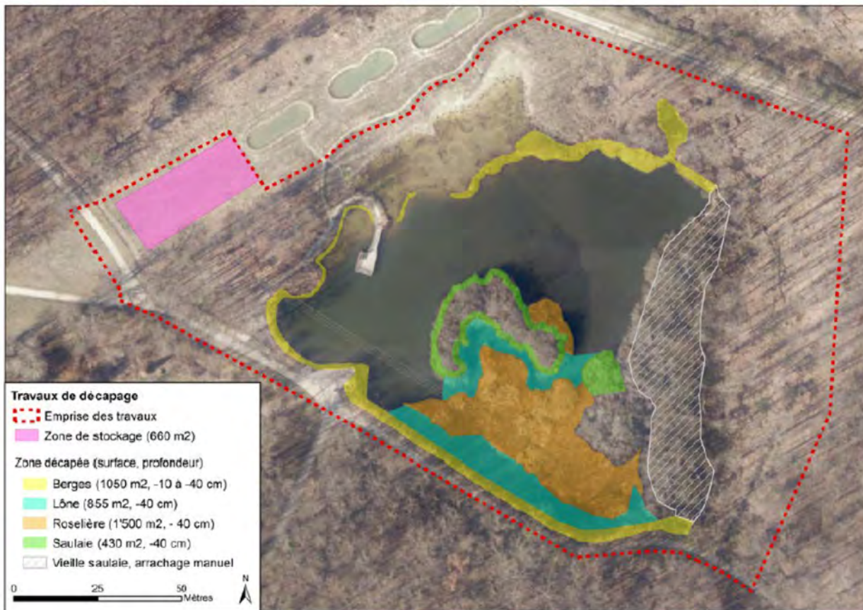
Plan des travaux de décapage avec zones travaillées (surfaces et profondeurs de décapage)
