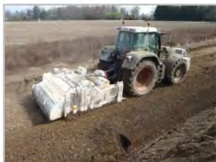
Broyage des rhizomes à la stabilisatrice et sondages ponctuels de contrôle, avril 2012
