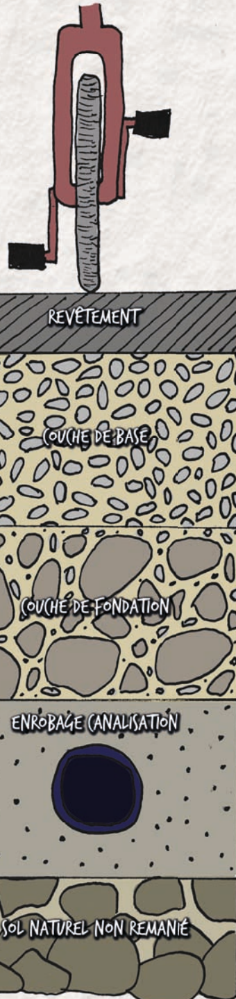
SOL URBAIN SCELLÉ
